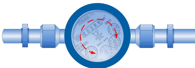
Vízmérő forgatható számlappal
